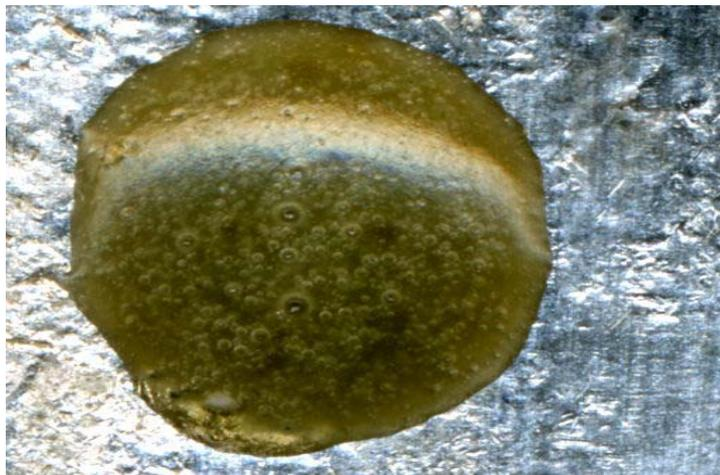
Рис. 6. Образец обезжелезненного стекла
